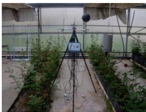
Figura 4. Disposición del medidor de ambiente térmico en el invernadero
