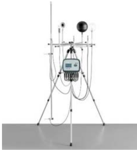
Figura 2. Medidor de ambiente térmico HD32.1 DeltaOHM
