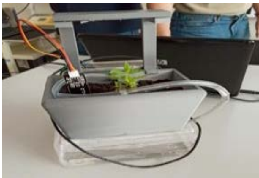
Figura 2. Prototipo de maceta para jardín vertical impresa en 3D
