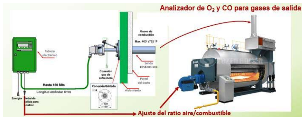
Figura 1. Control del Aire de Combustión en una Caldera.
