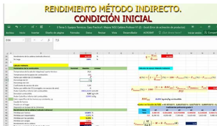
Figura 7. Medidas realizadas en la caldera para la determinación del rendimiento por el método indirecto. Condición inicial.
