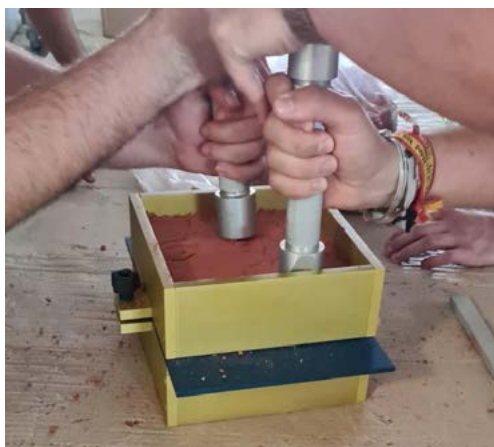
Figura 4. Realización del molde en arena
