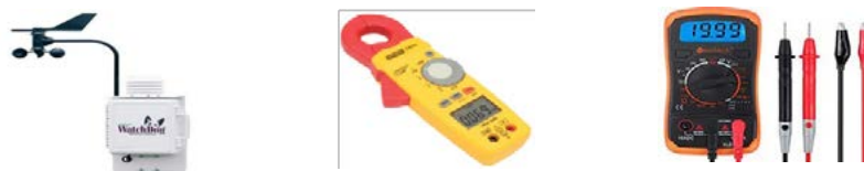
Figura 2. Equipos de medida. Izquierda: Estación meteorológica WatchDog Series 2000. Centro: Pinzas amperimétricas. Derecha: Multímetro
