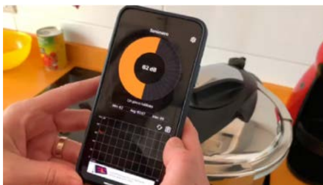
Figura 3. Medida del nivel de intensidad sonora generado por una fuente puntual en interior con la aplicación Sonómetro (iOS).
