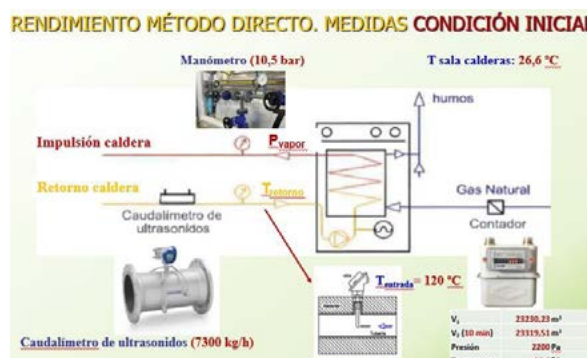
Figura 3. Medidas realizadas en la caldera para la determinación del rendimiento por el método directo
