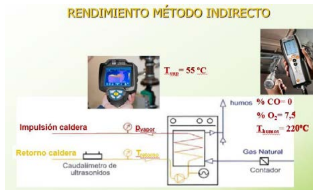
Figura 6. Medidas realizadas en la caldera para la determinación del rendimiento por el método indirecto
