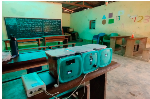
Figura 6: Incubación de muestras de aguas en la incubadora WATA 1.0. Mimbil, Este de Camerún.
