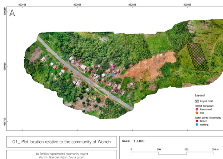
Figura 3: Parcela dibujada en ortofoto obtenida con vuelo de dron, en Worreh.
