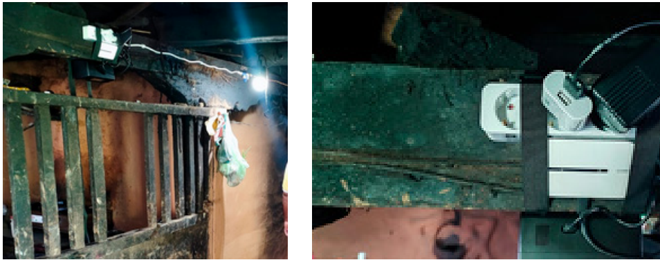
Figura 5: Los nodos de sensores se instalaron en una ubicación representativa del hogar, a una altura mínima de 1.5m del suelo.
