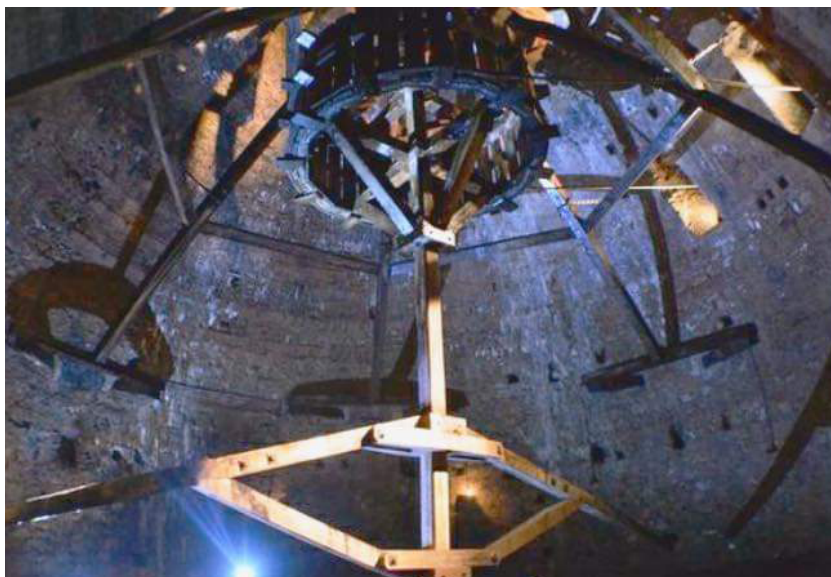
Figura 12. Torno de caballerías de la mina de Almadén (Baritel de San Andrés, s. XVIII).
