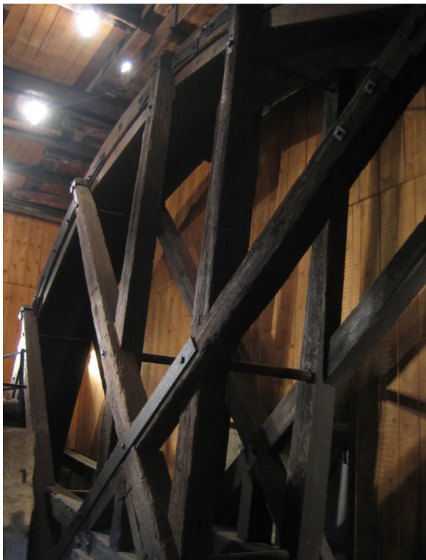
Figura 5. Noria de desagüe de la mina de mercurio de Kamst Idrija.
