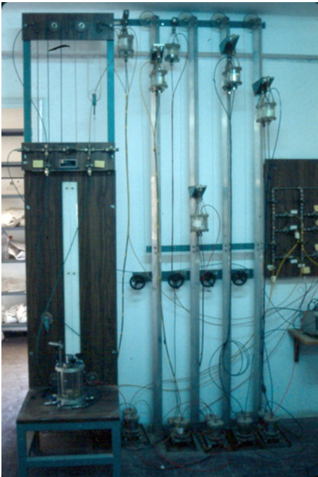
Fig. 1.4a Diversos triaxials en funcionament.
