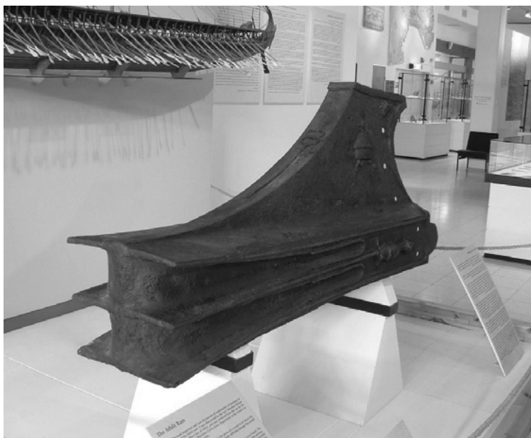
Fig. 6. Espolón de bronce perteneciente a un barco griego del siglo II a.C. encontrado en Atlit (Israel), Museo Marítimo Nacional de Haifa. Fuente: Wikimedia Commons.
