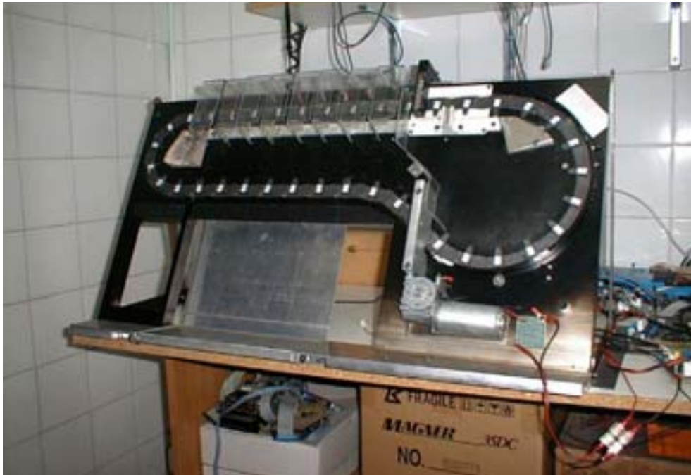
Figura 1.8 Diseño original: Máquina universal de clasificar monedas ; prototipo funcional (Ibersélex S.A.)
