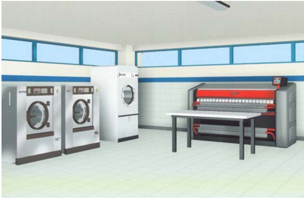
Figura 1.4 Tipología de gama de máquinas para lavandería de pequeña y mediana instalación: lavadoras-centrifugadoras, secadoras, planchadoras.
