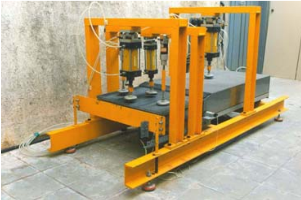
Figura 1.6 Producto fabricado en pequeña serie: Módulo de andén de geometría variable : módulo y banco de ensayo (F. Generalitat de Catalunya S.A.)
