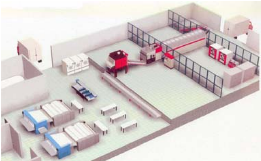
Figura 1.5 Tipología de gama de máquinas para lavandería de gran instalación: túnel de lavado, prensa, secadoras grandes, calandras y plegadoras.
