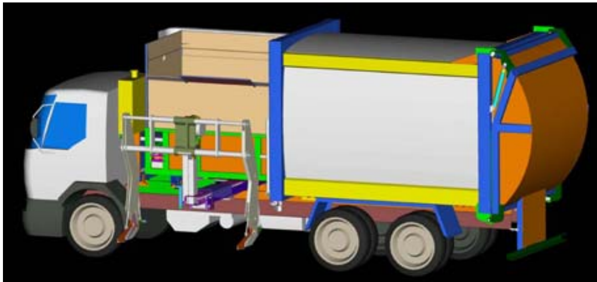
Figura 1.9 Diseño de adaptación: Unidad monooperada de recogida de basura de carga lateral ; modelización 3D (Ros Roca S.A.)
