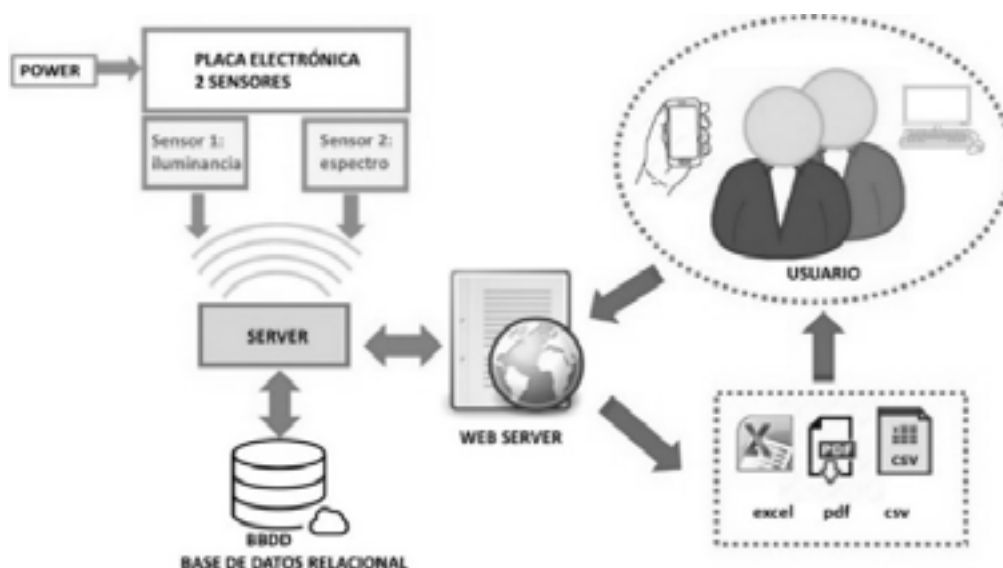
Figura 1. Diagrama de bloques basado en el desarrollo tecnológico de la sensórica, el IoT y el tratamiento masivo de datos (Big Data).
