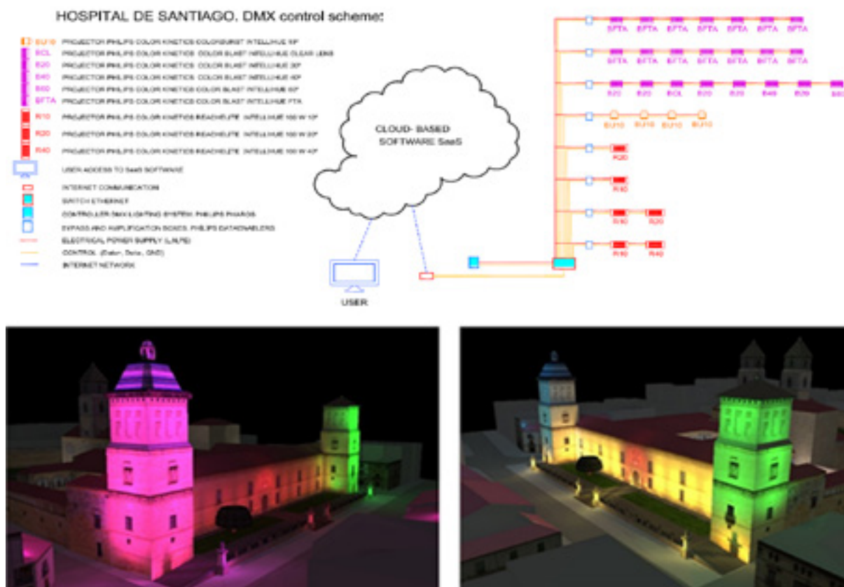
Figura 3. Propuesta. Esquema de control y simulación DiaLux. Elaboración propia.
