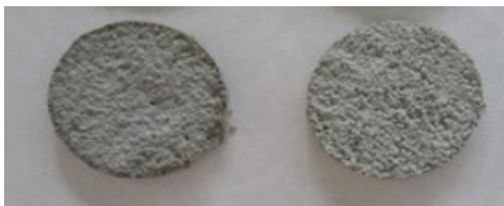
Figura 2. Probeta de mortero con LDH como aditivo.
