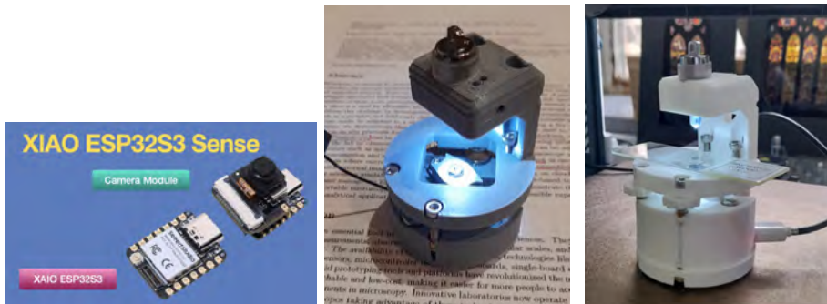
Figura 3. Microcontrolador ESP32S3 y módulo de cámara (izqda.). Microscopios de bolsillo: prototipos construidos (centro y dcha.)
