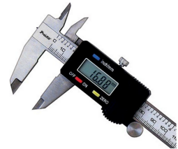
Fig. 1.15: Pie de rey con salida digital
