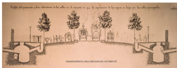
FIGURA 1a Deducción de la sección viaria de Cerdá según el principio de independencia de los modos de transporte Fuente: Cerdá (1855)
