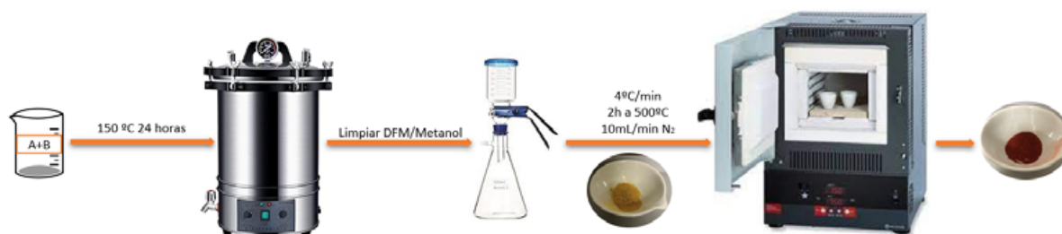
Ilustración 2: Proceso síntesis de catalizador.
