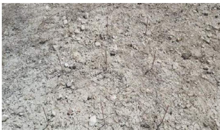
Ilustración 1: Sistema para medir la pérdida de suelo por erosión hídrica.
