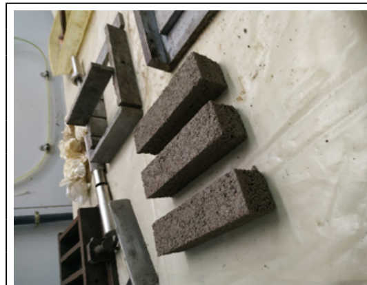
Figura 1. Probetas de mortero poroso.
