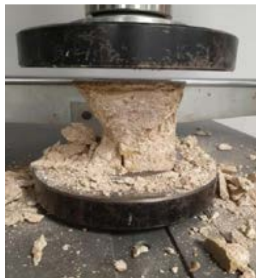
44 | Ensayo de rotura a compresión de la probeta del tapial
