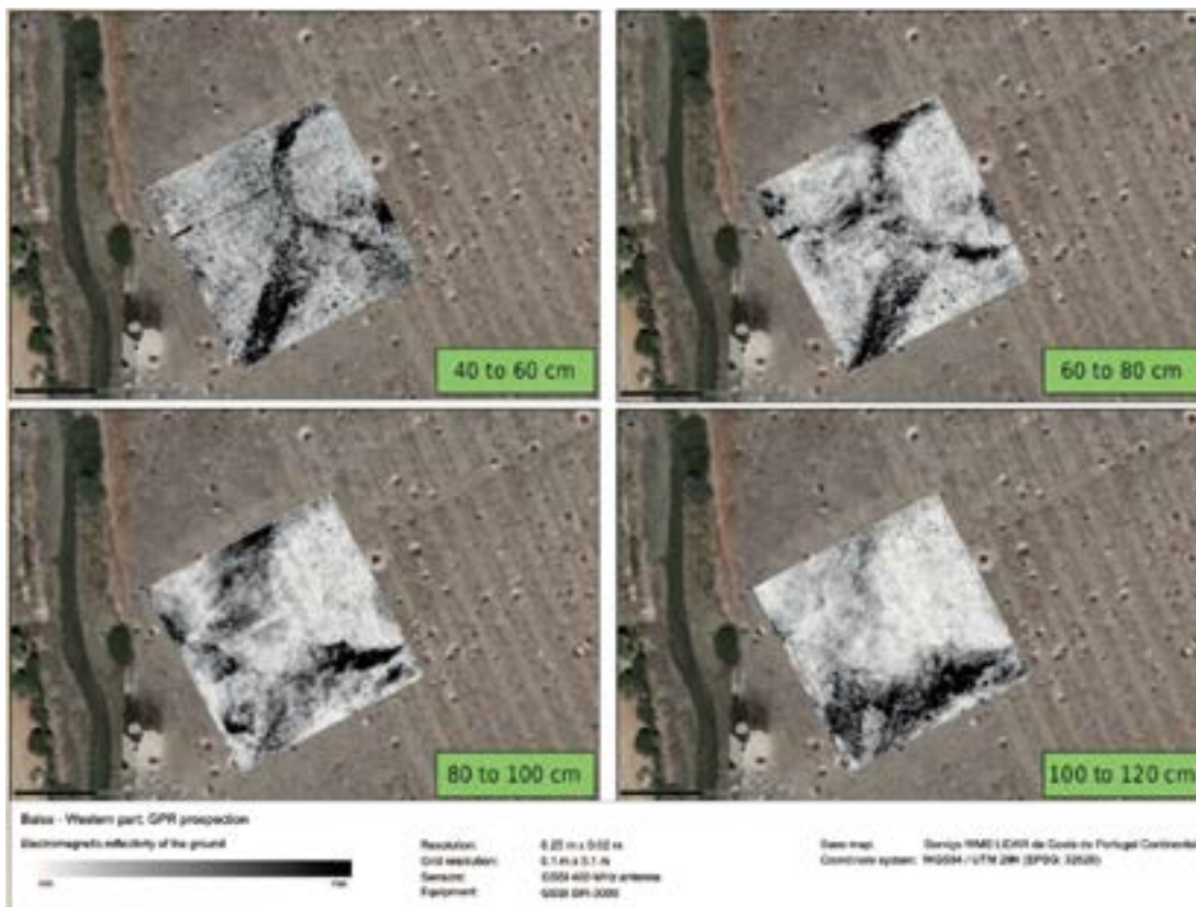
Fig. 3. Medições por Georadar vendo-se indícios de eventuais estruturas portuárias (Meyer, Goossens e Freibothe, 2022, 1786, fig. 9).
