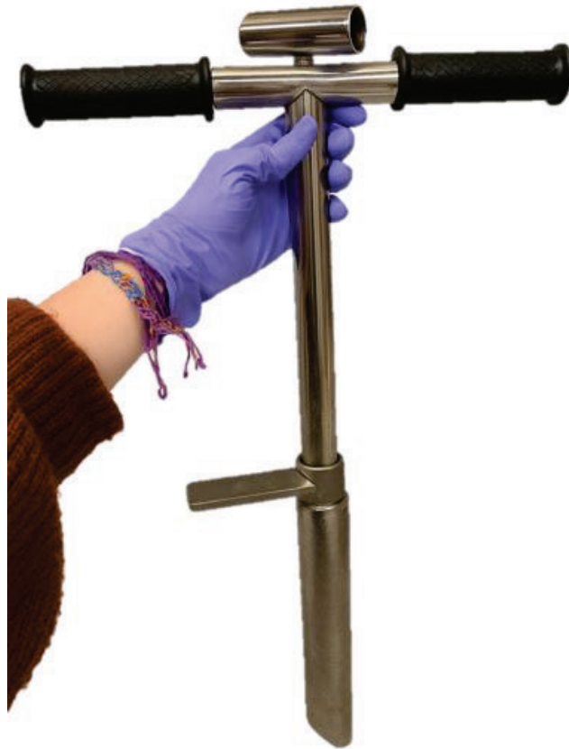
Figura 5. Ejemplo de un modelo de corer para tomar muestras de suelo.
