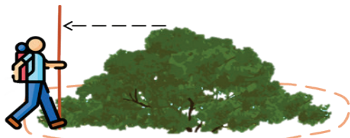
Figura 6. A) Elegida al azar la dirección del transecto, calcular la distancia entre las macollas ( n^{\circ} mínimo = 25). Contabilizar y medir los individuos de S. oppositifolia y L. intricatum entre macollas. B) Estimar la altura de la macolla desde la base de esta (vara graduada) y el perímetro de la macolla (pasos de aproximadamente 1 m). C) Estimar la longitud máxima (en planta) de la mancha mayor de S. oppositifolia y/o L. intricatum en la macolla, así como de los individuos entre macollas.
