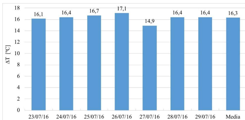
Figura 3. Diferencia de temperatura de los forjados entre la cubierta tradicional y la cubierta verde.
