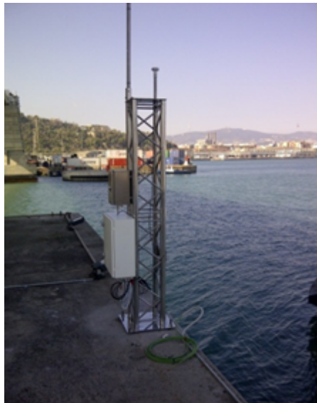
Figura 4.19. Mareògraf acústic del Port de Barcelona [33]
