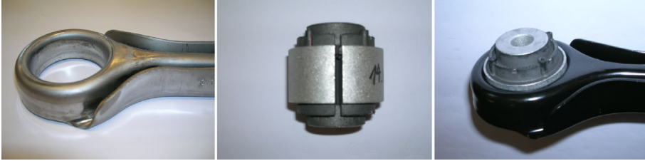
Fig. 10.16 (a) Brazo de control y detalle del orificio (b) Foto de perfil del cojinete ranurado goma-metal, (c) Brazo de control terminado, con el rodamiento encajado a presión.
