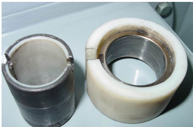
Fig. 12.5 Parte de un cojinete de deslizamiento hecho en acero al manganeso, al que se ha incorporado un recubrimiento de polímero para suprimir el ruido por rozamiento.
