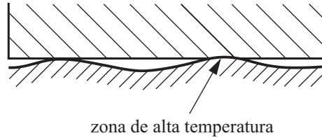
Fig. 13.1 Las zonas de mayor temperatura se aplanan por efecto de la dilatación térmica, lo cual conduce a una mayor potencia de fricción y, por tanto, a un mayor calentamiento en dichas regiones. Esto puede causar una inestabilidad y la aparición de un patrón de deformación permanente.
