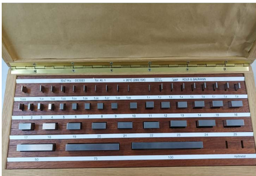
Figura 7. Distintos juegos de bloques patrón longitudinales de 47 piezas.
