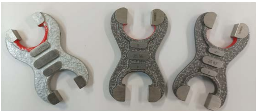
Figura 2. Calibres de tolerancias o de límites de herradura para la verificación de ejes.
