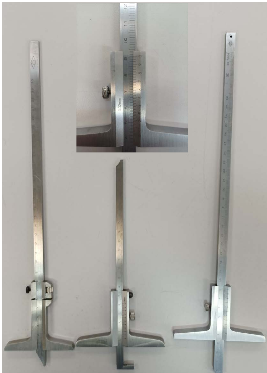
Figura 16. Sonatas de profundidad que emplean el nonius como sistema de lectura. Detalle de la escala de medición.
