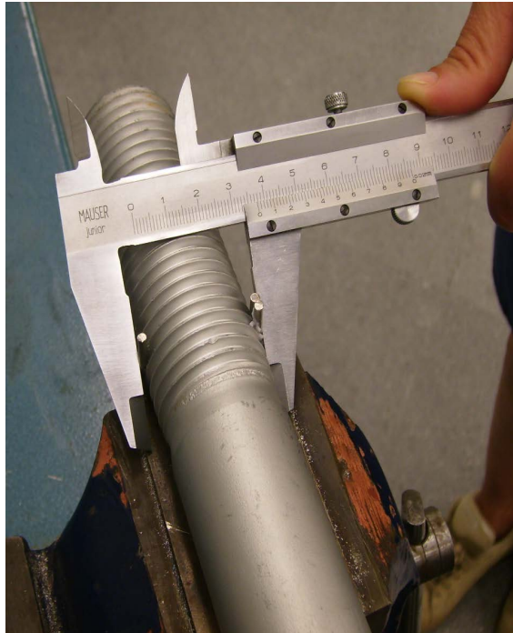
Figura 12. Medición del diámetro de flancos de un tornillo M36 mediante varillas y pie de rey.
