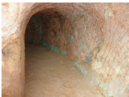
Figura 3. Pequeña galería romana de exploración ( ternagus ) en la masa de Filón Sur de Tharsis.
